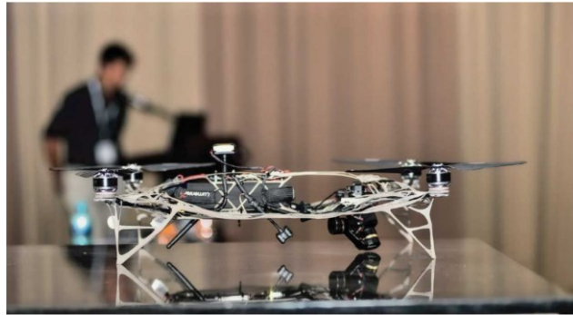
使用 Inspire 优化的 3D 打印无人机框架
