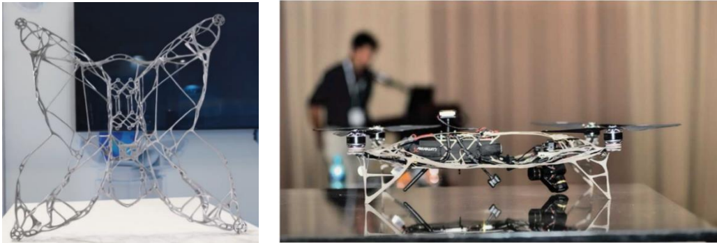
使用 Inspire 优化的 3D 打印无人机框架
