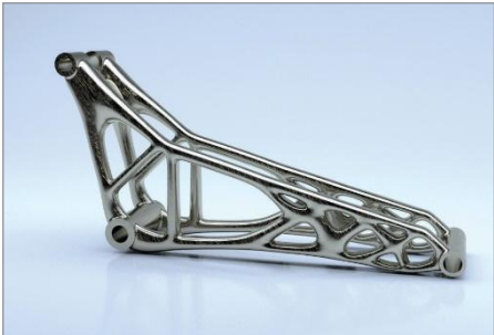
优化3D打印自行车摇臂成果
